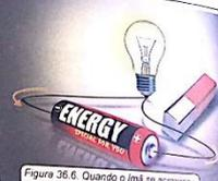
Figura 36.6. Quando o ímã se aproxima do se afasta do fio, o lâmpada se acende.
