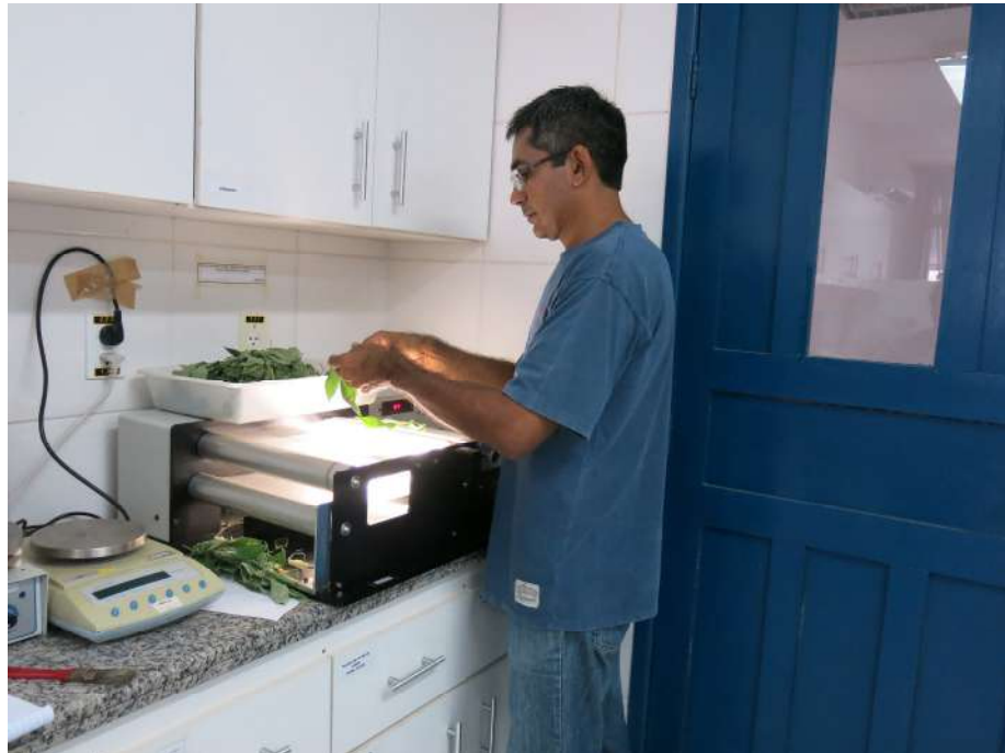
Medição da área foliar utilizando aparelho LI-300 Li-cor Area Meter. Fotos: Edmilson E. da Silva.
