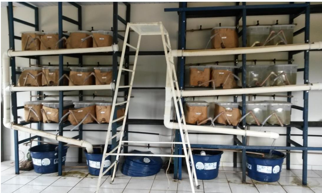
Figura 4 - Unidades experimentais com 18 caixas de 40 litros que possuem uma área de superfície equivalente a 0,75 m 2 de lâmina d'água com recirculação d'água.
