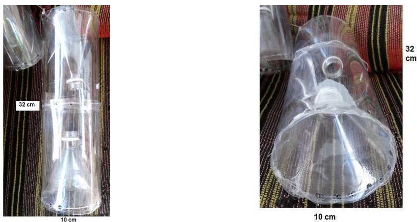
Figura 2 - Exemplar da armadilha tipo “matapi” de PET e suas dimensões.
